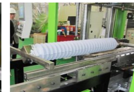
制品名称: 110kV避雷器 成型腔数: 一出二 Part Name: 110kV Arrester Number of Cavities: 1
