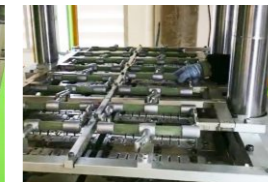
制品名称: 11kV熔断器 成型腔数: 一出十六 Part Name: 11kV Cut-out Number of Cavities: 16
