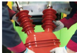
制品名称: 10kV互感器 成型腔数: 一出二 Part Name: 10 kV Transformer Number of Cavities: 1
