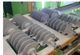
制品名称: 38kV避雷器 成型腔数: 一出八 Part Name: 38 kV Arrester Number of Cavities: 8
