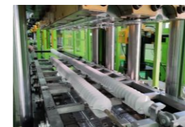
制品名称: 500kV高压复合绝缘子 成型腔数: 一出二 Part Name: 500 kV HV Composite Insulator Number of Cavities: 2
