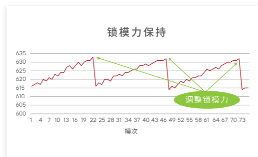
*图示曲线为因连续生产模温升高模具膨胀导致锁模力逐渐升高「智能锁模力保持」功能自动调整的展示
